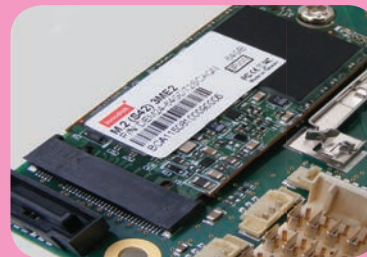
M.2 Mini Card Socket with M.2 Mini Card
